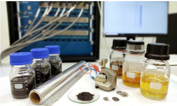
Die wichtigsten Komponenten einer Aluminium-Ionen-Batterie: Graphitpulver, Aluminium-Folie und ein spezieller Elektrolyt, der aus einer bei Raumtemperatur flüssigen Salzschmelze besteht. Copyright: Maximilian Wassner / Fraunhofer THM Batterie 4.0 (fraunhofer.de)
