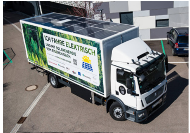
Die besonders leichten und robusten PV-Modul-Prototypen wurden in den Kofferaufbau des E-LKW integriert. Copyright: Fraunhofer ISE https://www.ise.fraunhofer.de/de/presse-und-medien/presseinformationen/2021/e-lkw-mit-vollintegrierter-photovoltaik-nimmt-fahrt-auf.html
