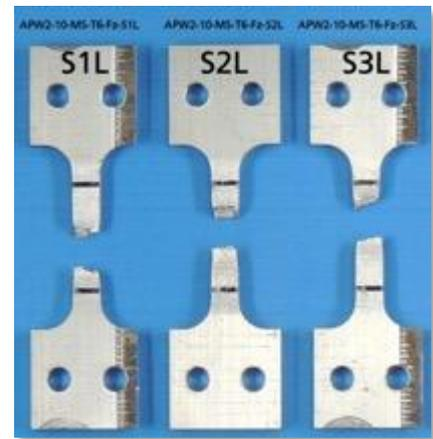
Abbildung 4-39: Glatte Zugproben nach Zugversuch (Einkammerprofil, V25, 480°C, 10m/min, mit Sprühnebel)
