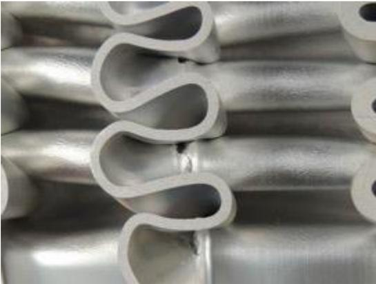
Abbildung 2-1: Ausschnitt eines gestauchten Aluminiumprofils [KRA15]
