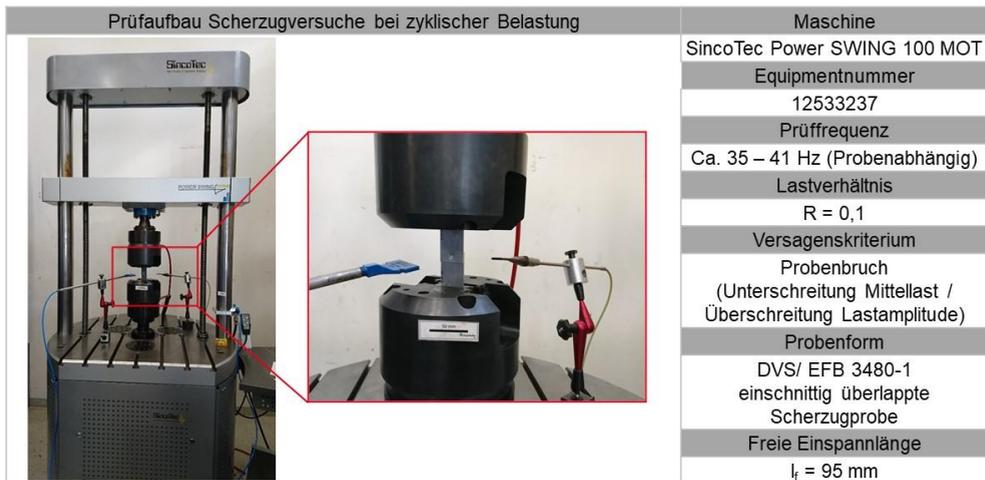
Abbildung 26: Prüfaufbau der Ermüdungsversuche unter zyklischer Scherzugbelastung
