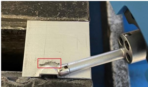
Abbildung 39: Ablagerungen (schwarze Partikel) zwischen den Blechen im Bereich des Clinchpunktes
