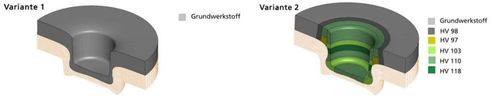
Abbildung 94: Halbmodell des Clinchpunktes für Lastsimulation. Links: Homogene Verteilung der zyklischen Materialeigenschaften im oberen Blech. Rechts: Segmentierung des oberen Blechs anhand der gemessenen Vickers Härte
