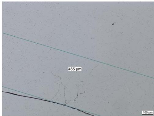
Abbildung 127: Ausgewählte mikroskopische Aufnahme des Risses im Bereich A; Abschaltkriterium  $\Delta f = 0,005$  Hz
