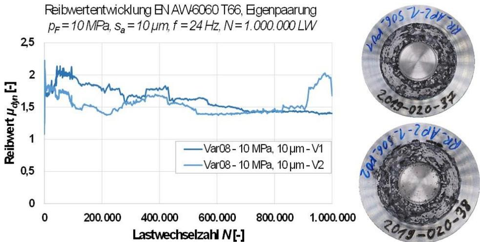
Abbildung 135: Reibwertverläufe und Schädigungsbilder der Serie 8
