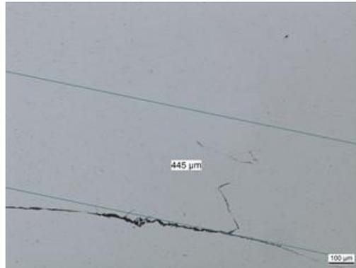
Abbildung 126: Ausgewählte mikroskopische Aufnahme des Risses im Bereich A; Abschaltkriterium  $\Delta f = 0,01$  Hz
