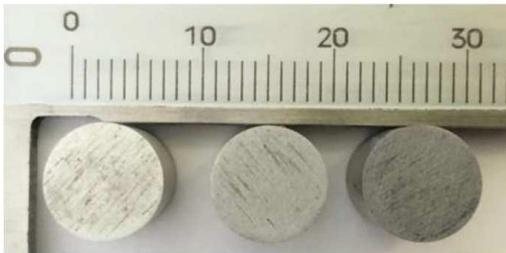
Abbildung 7: pulvermetallurgisch hergestellte (SPS gesintert) Verbundwerkstoffproben mit 0%, 10%, 20%, 30% und 40% Volumenanteil Kieselalgenhüllen (DE "Perma Guard")
