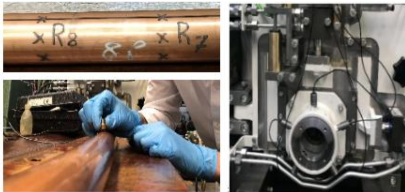
ABBILDUNG 25: MANUELLE WANDSTÄRKEMESSUNG(LINKS),INTEGRIERTES ULTRASCHALL-MESSSYSTEM AUF DER VERSATZMATRIZE (RECHTS).
