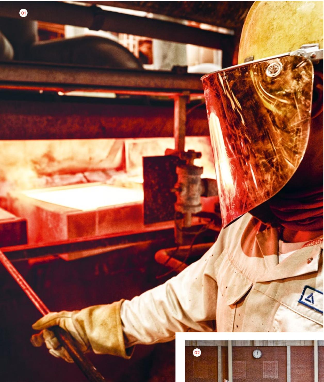
01 Mit bis zu 1300 Grad geht es rund – Am Gießrad werden Kupferanoden gegossen.
